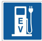
Vehículo eléctrico cargando
