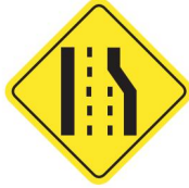
El carril derecho termina
